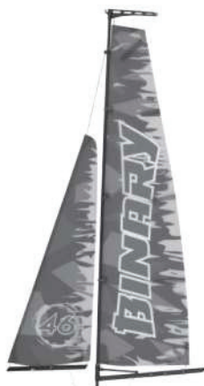
Mast mit Fock- und Großsegel und Fock- und Großbaum
