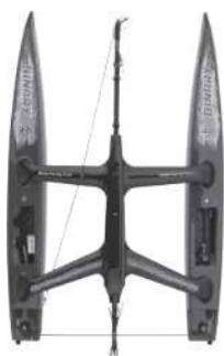
BINARY Katamaranrumpf (Servos, Empfänger und Batteriehalter sind vorinstalliert)
